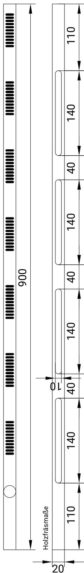
Lüftungsprofil 900 mm
