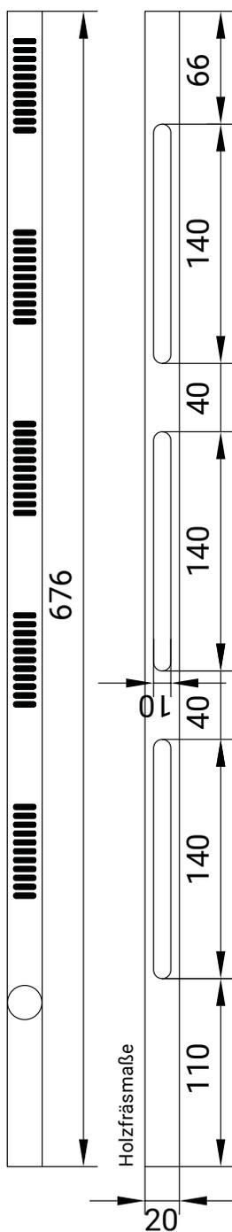
Lüftungsprofil 676 mm
