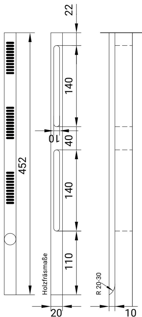
Lüftungsprofil 452 mm
